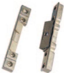
Bandsicherung Die Bandsicherung (gegen Aufpreis) auf der Bandseite bietet eine zusätzliche Sicherheit. Diese dient dazu, dass die Tür weder ausgehebelt noch weggedrückt werden kann. Die schrägen Flächen der Bandsicherung verkeilen sich ineinander und lassen ein Öffnen nicht zu.
