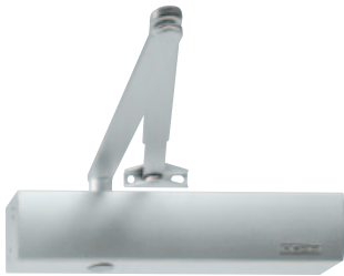
Obertürschließer TS 4000 Türschließer mit Gestänge (Feststellwinkel bis 150°). Von vorn einstellbare Schließkraft, Schließgeschwindigkeit und Öffnungsdämpfung mit optischer Größenanzeige. Lieferbar in den Farben: Silber, Braun, Weiß.
